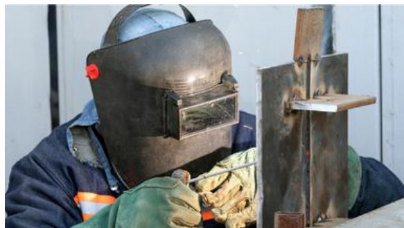
Εικόνα 3.2: Κάθετη συγκόλληση με ηλεκτρικό τόξο
