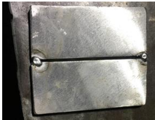
Εικόνα 7.14: Υπόστρωμα που χρησιμοποιείται στη συγκόλληση αλουμινίου.
