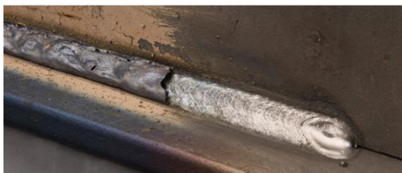
Εικόνα 1.11: Προστατευτική επίστρωση της συγκόλλησης
