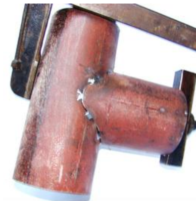
Εικόνα 9.19: Συγκόλληση με κόλληση σωλήνων με κομμένες και τοποθετημένες διασταυρώσεις
