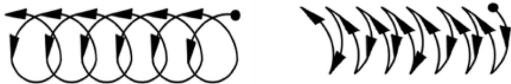
Εικόνα 1.16: Συνιστώμενες κινήσεις ηλεκτροδίων για περάσματα πλήρωσης
