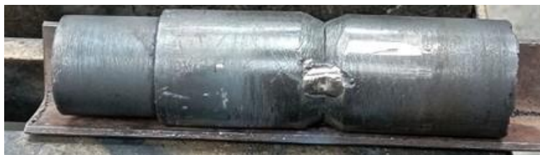
Εικόνα 6.9: Προετοιμασία αυλάκωσης συγκόλλησης
