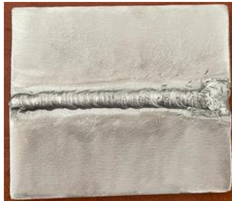
Εικόνα 7.19: Συγκόλληση αρμών αλουμινίου
