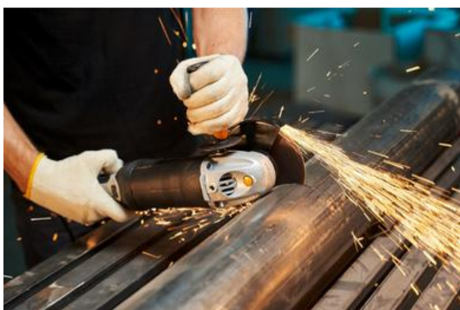
Εικόνα 9.5: Τοποθέτηση και αφαίρεση γρεζιών
