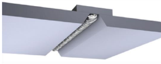
Εικόνα 4.10: Εναέρια συγκόλληση V
