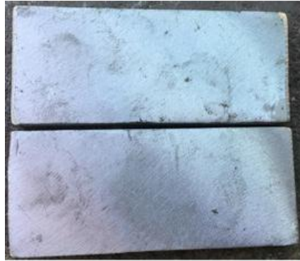
Εικόνα 7.17: Εξάρτημα αλουμινίου με καθαρισμό επιφάνειας
