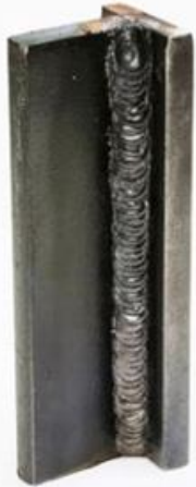
Εικόνα 3.4: Ολοκληρωμένη συγκόλληση γωνιακή από κάτω προς τα πάνω
