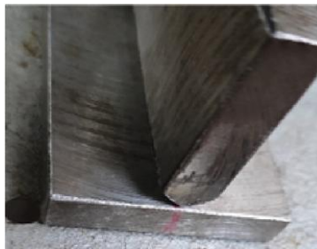
Εικόνα 1.14: Συγκόλληση με κόλληση σε συγκόλληση K-Groove Κατά την εκτέλεση μεγάλων περασμάτων συγκόλλησης, θα πρέπει να εφαρμόζεται η κατάλληλη κίνηση του ηλεκτροδίου.
