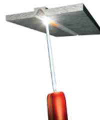
Εικόνα 4.9: Εναέρια συγκόλληση άκρη με άκρη
