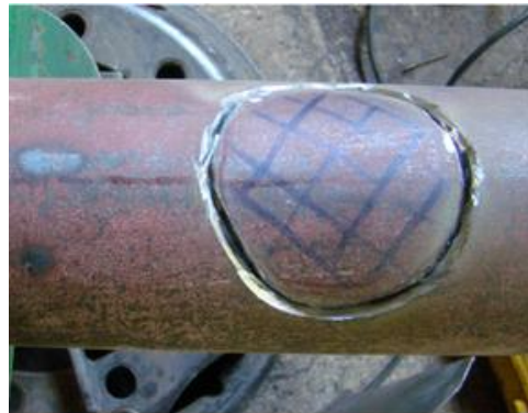
Εικόνα 9.18: Κοπή της διατομής με μηχανή αφαίρεσης τσιπ
