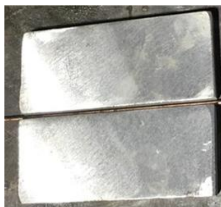
Εικόνα 7.13: Τμήμα αλουμινίου με καθαρισμένη επιφάνεια
