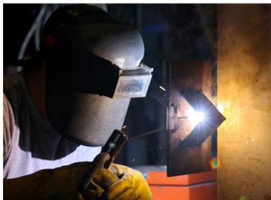
Εικόνα 4.1: Συγκόλληση πλευρικής άρθρωσης
