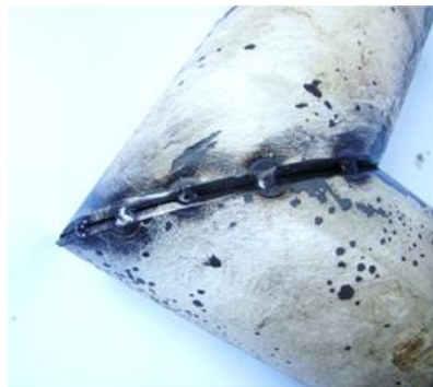
Εικόνα 9.23: Συγκόλληση με κόλληση του αγκώνα L
