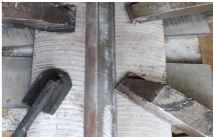
Εικόνα 1.7: Πρόληψη συρρίκνωσης συγκόλλησης με χρήση εξαρτήματος.
