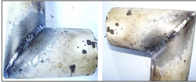
Εικόνα 9.24: Συγκόλληση αγκώνα L
