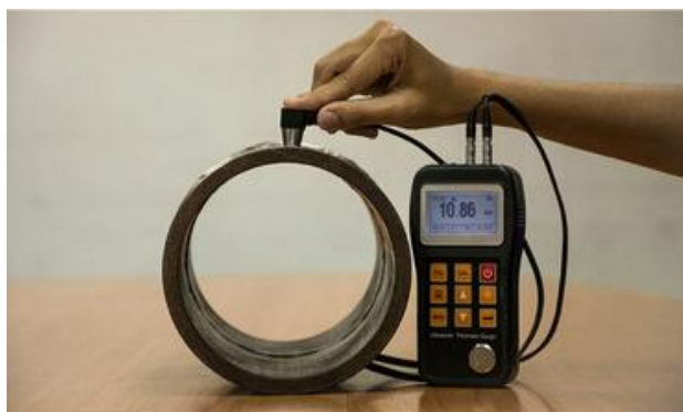
Εικόνα 9.26: Συσκευή επιθεώρησης υπερήχων
