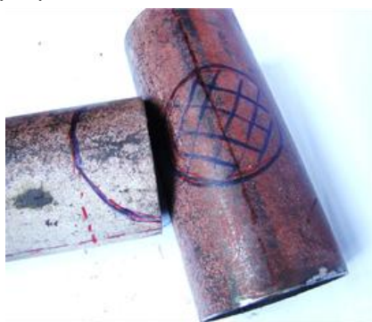
Εικόνα 9.16: Σωλήνες με διατομές κομμένες και λοξότμητες, σχηματίζοντας έναν τμηματοποιημένο αγκώνα
