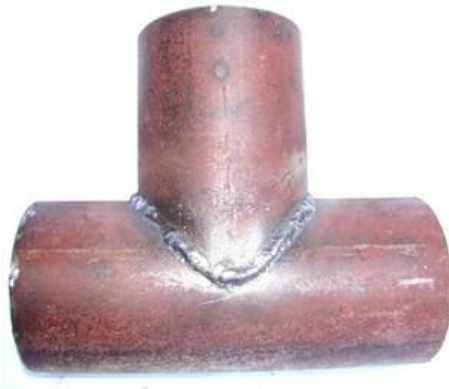
Εικόνα 9.20: Συγκόλληση σωλήνων με λοξότμητο (T) σύνδεσμο
