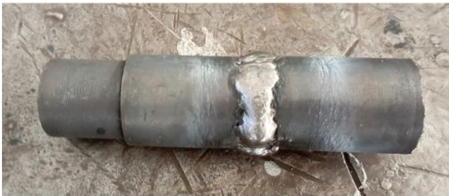
Εικόνα 6.10: Συγκολλημένος σπασμένος χυτοσίδηρος
