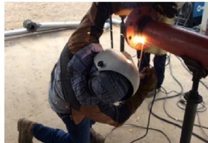
Εικόνα 4.11: Εφαρμογές εναέριας συγκόλλησης V
