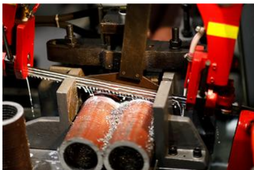
Εικόνα 9.10: Κοπή σωλήνων με πριονοκορδέλα
