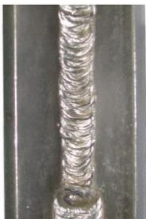
Εικόνα 3.4: Ολοκληρωμένη συγκόλληση γωνιακή από κάτω προς τα πάνω
