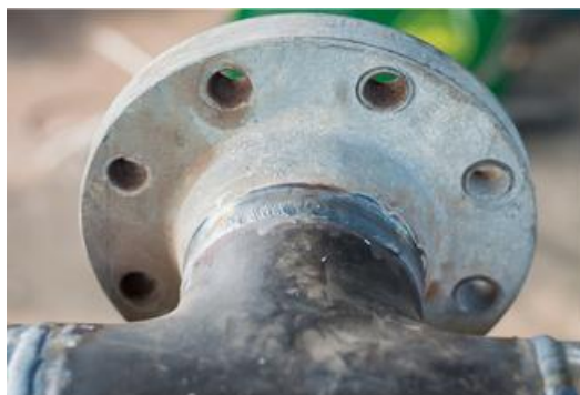
Εικόνα 9.14: Εξωτερική συγκόλληση της φλάντζας
