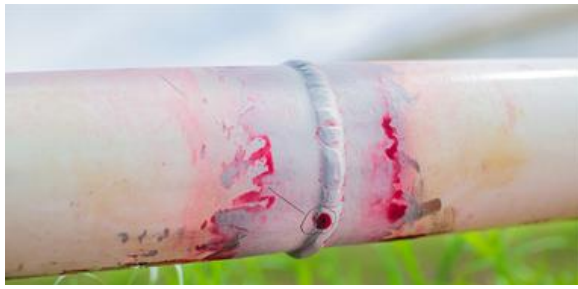
Εικόνα 9.27: Επιθεώρηση με βαφή
