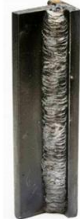
Εικόνα 3.4: Ολοκληρωμένη συγκόλληση γωνιακή από κάτω προς τα πάνω
