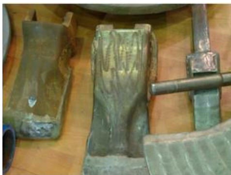
Εικόνα 8.2: Συγκόλληση φθαρμένων εξαρτημάτων
