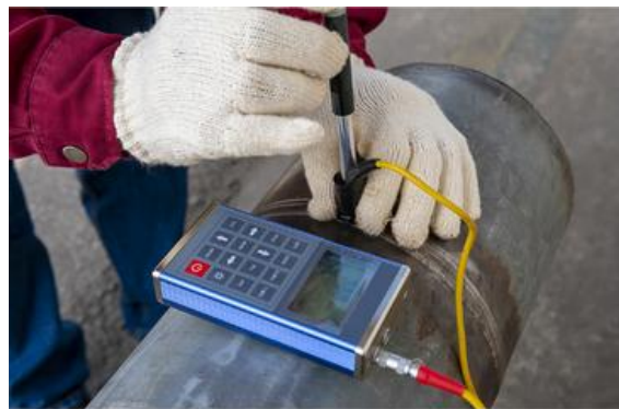
Εικόνα 9.28: Συσκευή δοκιμής μέτρησης σκληρότητας
