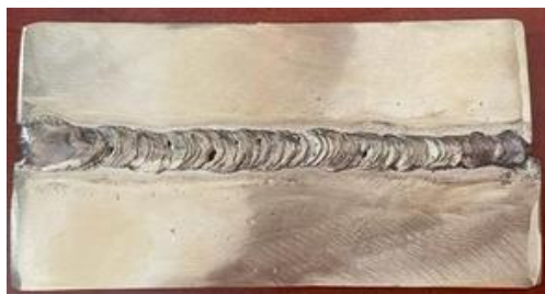
Εικόνα 7.11: Συγκόλληση ορειχάλκινων αρμών
