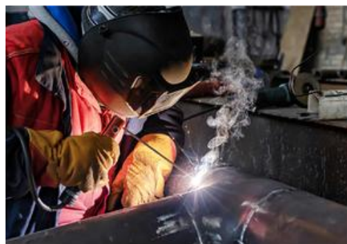
Εικόνα 5.1: Άρθρωση άκρου με κυτταρινικό ηλεκτρόδιο
