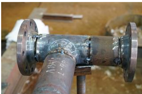
Εικόνα 9.13: Συγκόλληση με κόλληση της φλάντζας
