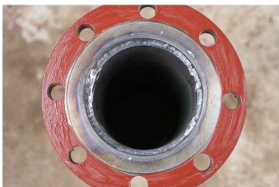
Εικόνα 9.14: Εξωτερική συγκόλληση της φλάντζας
