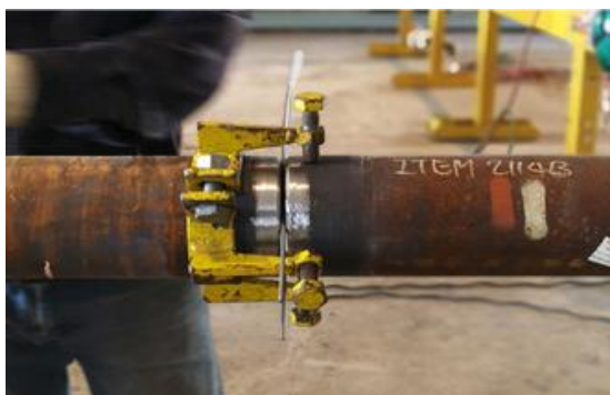
Εικόνα 9.9: Συσκευή που χρησιμοποιείται για την προετοιμασία του άκρου του σωλήνα
