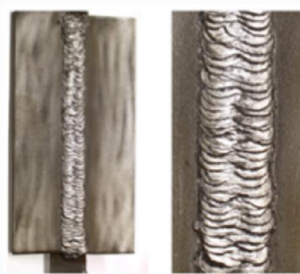
Εικόνα 3.3: Εφαρμογή συγκόλλησης από κάτω προς τα πάνω
