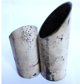
Εικόνα 9.22: Γωνιακή κοπή L αγκώνα
